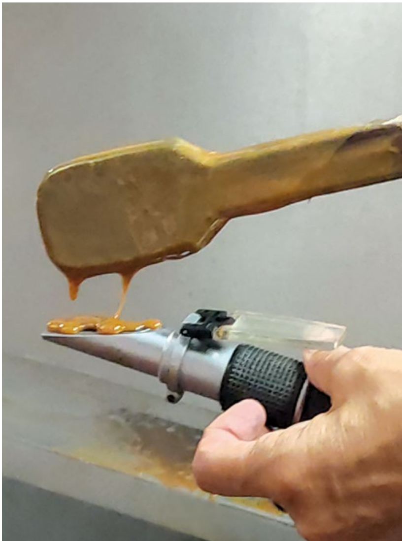
Determinación del punto final del dulce de leche con refractómetro.
